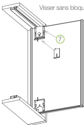
7 - Mettre en place la porte et fixer la platine pivot haut
